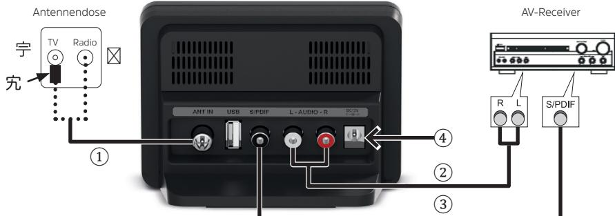
① ANT IN: Verbinden Sie den Antenneneingang des **CABLESTAR 100** mit der Antennendose um das Gerät mit dem Kabelsignal zu verbinden. Verwenden Sie hierfür beiliegendes Antennenkabel.
