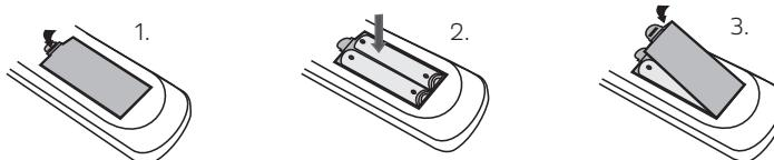
2. Plaats 2 x AAA 1.5 V batterijen in de afstandsbediening en houd daarbij rekening met de polariteit. De richting wordt aangegeven in het batterijvak.
