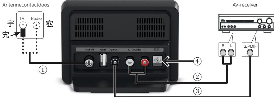
① ANT IN: Verbind de antenneaansluiting van de **CABLESTAR 100** met de antennecontactdoos om het apparaat op het kabelsignaal aan te sluiten. Gebruik hiervoor de bijgeleverde antennekabel.
